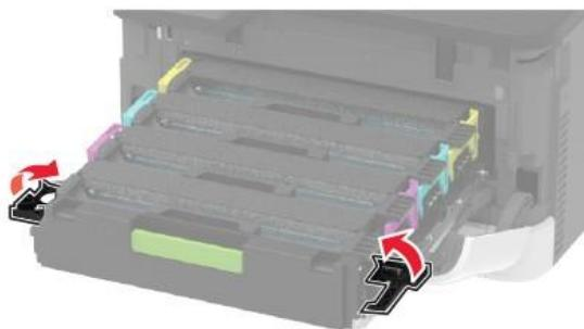
**6** Установите лоток с картриджами, затем закройте дверцу.
